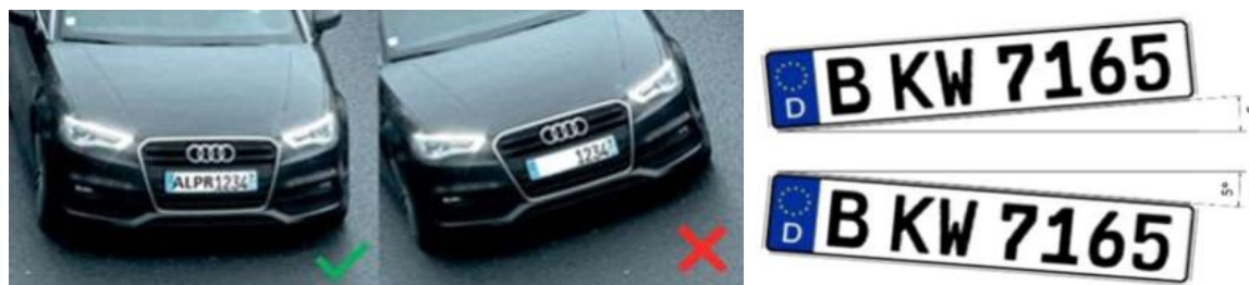
Рисунок 5.4 – Варіанти кута нахилу камери
