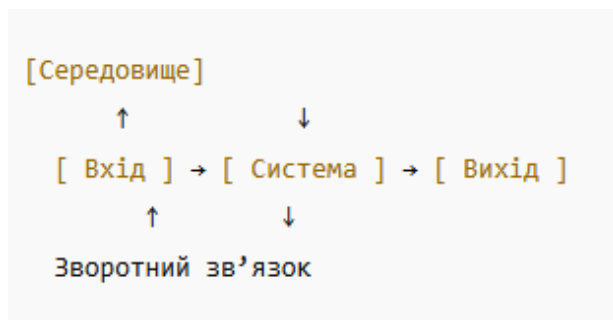
Рис. 1.2. Схема відкритої системи з входами, виходами та зворотним зв'язком у взаємодії з середовищем.
