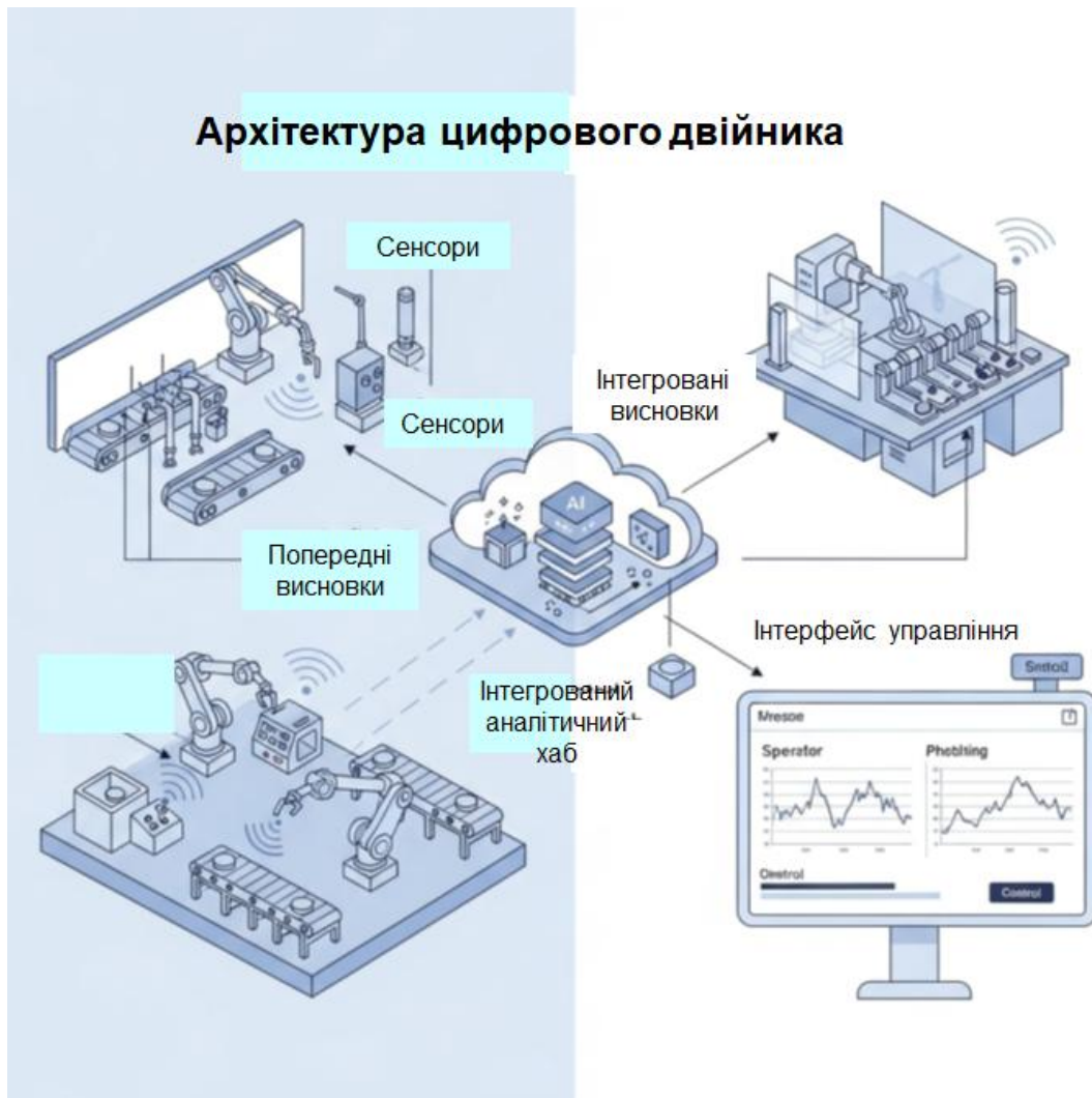
Рис. 3.8. Граф: Взаємодія між реальним об'єктом та цифровим двійником [СХЕМА: Digital Twin Architecture – фізична система ↔ сенсори ↔ аналітика ↔ інтерфейс управління].
