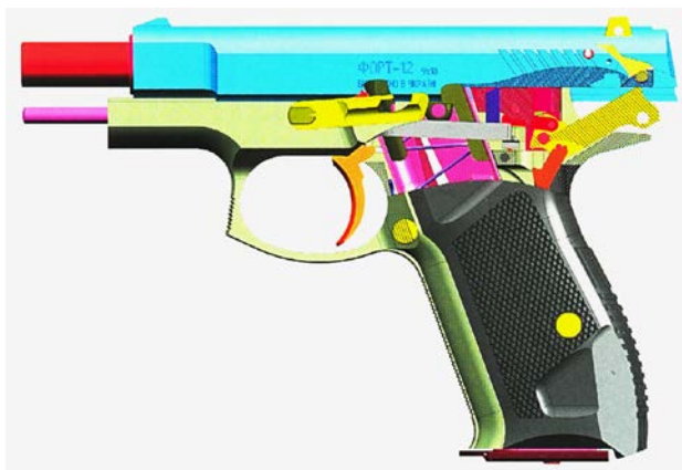
Положення частин і механізмів пістолета ФОРТ-12 після використання всіх патронів
