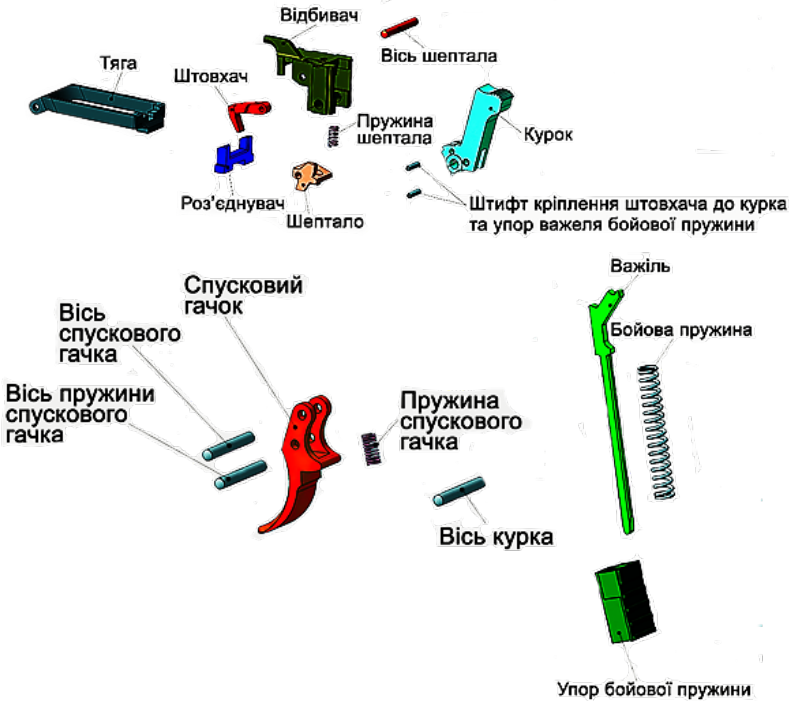
Частина ударно-спускового механізму пістолета ФОРТ-17
