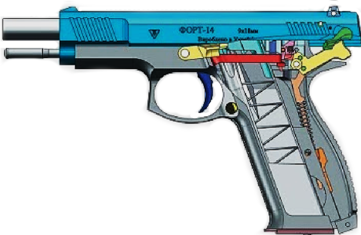
Положення частин і механізмів пістолета ФОРТ-14 після використання всіх патронів
