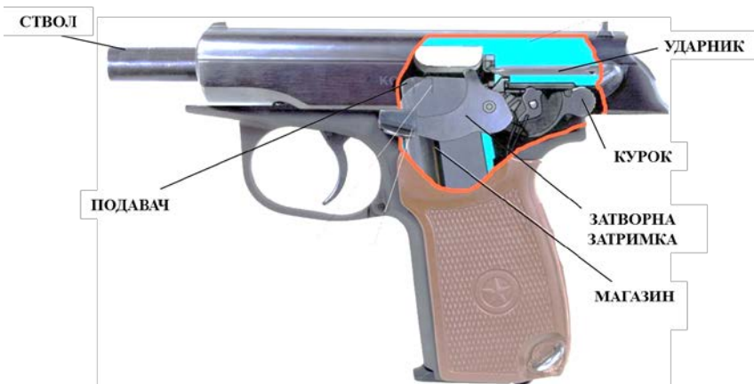
Розташування частин і механізмів пістолета Макарова
