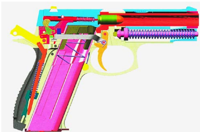
Положення частин і механізмів пістолета ФОРТ-12 перед пострілом при зведеному курку та увімкненому запобіжнику
