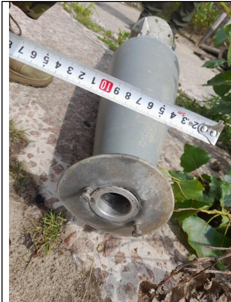
Мале гальмівне кільце 220 мм реактивного снаряду
