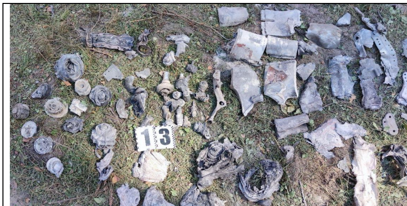
Деформовані уламки складових ракети
