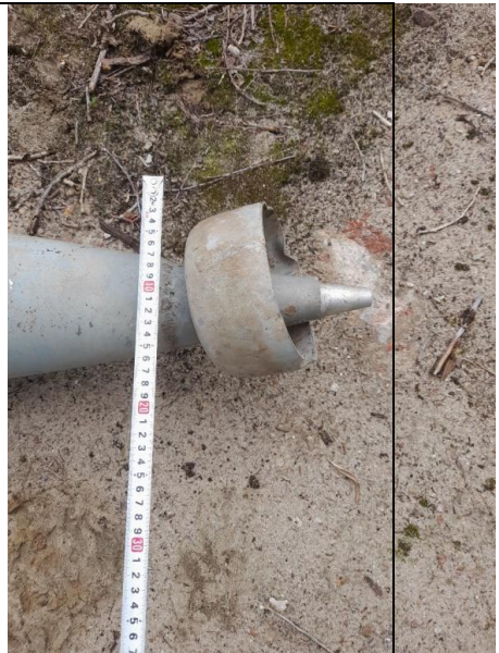
Велике гальмівне кільце 220 мм реактивного снаряду
