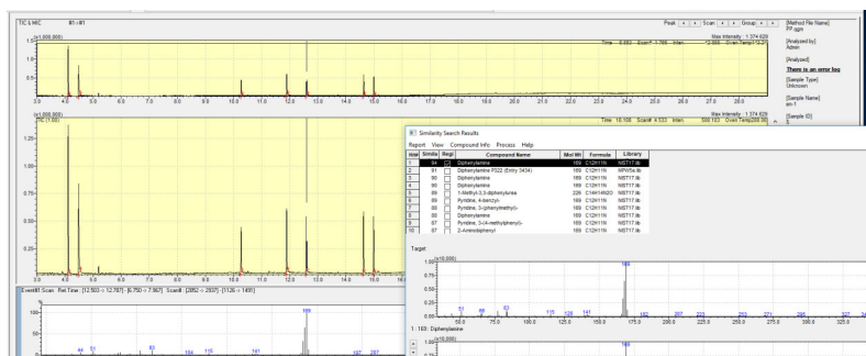
Рис. 2. Газохроматографічне дослідження зразка порошу марки «Сокол»
