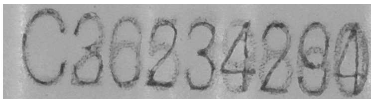
Мал. 2. Зображення ідентифікаційного номеру на якорі пломби, що виконане за допомогою компаратора відеоспектрального «Regula» в режимі з ІЧ-променями: верхній ІЧ при довжині хвилі 870 нм та інтенсивності 72 мВт.
