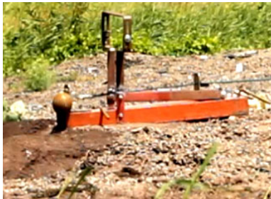
Мал. 2. Фотографія перекидання важеля в момент витягування чеки підричника гранати
