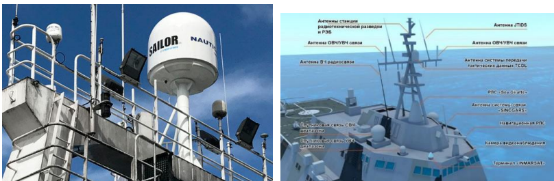
Рис. 1. Суднова антена система Sailor 900 і радіоелектронне обладнання корабля прибережної зони LCS
