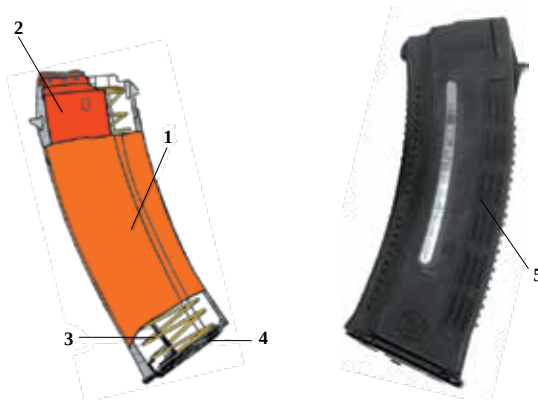
1 — корпус магазину; 2 — подавач; 3 — пружина подавача; 4 — кришка магазину
