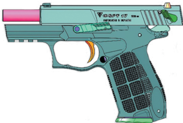
Положення частин і механізмів пістолета ФОРТ-17 після використання всіх патронів
