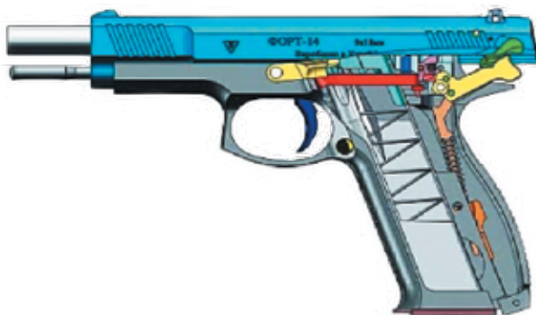
Положення частин і механізмів пістолета ФОРТ-14 після використання всіх патронів
