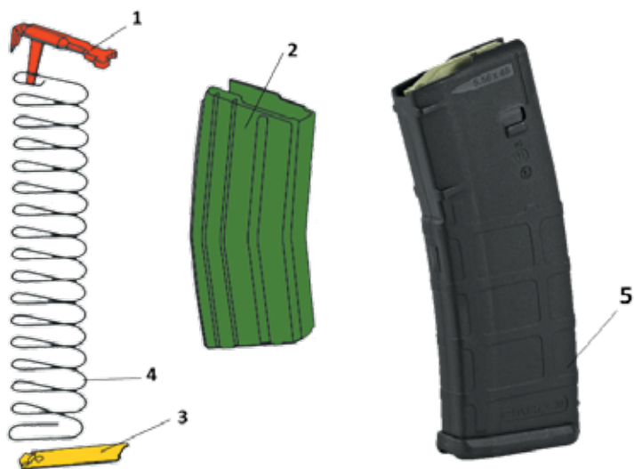
1 — подавач (magazine follower); 2 — корпус магазину (magazine box assy); 3 — нижня кришка магазину (magazine floor); 4 — пружина подавача (magazine spring)
