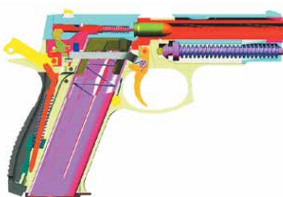
Положення частин і механізмів пістолета ФОРТ-12 перед пострілом при зведеному курку та увімкненому запобіжнику
