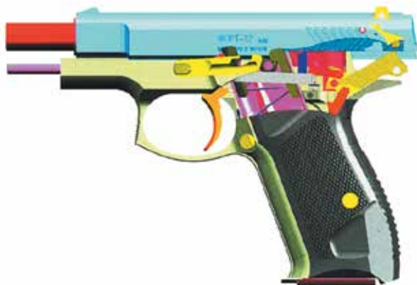
Положення частин і механізмів пістолета ФОРТ-12 після використання всіх патронів
