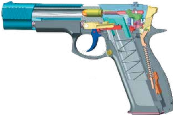
Положення частин і механізмів пістолета ФОРТ-14
