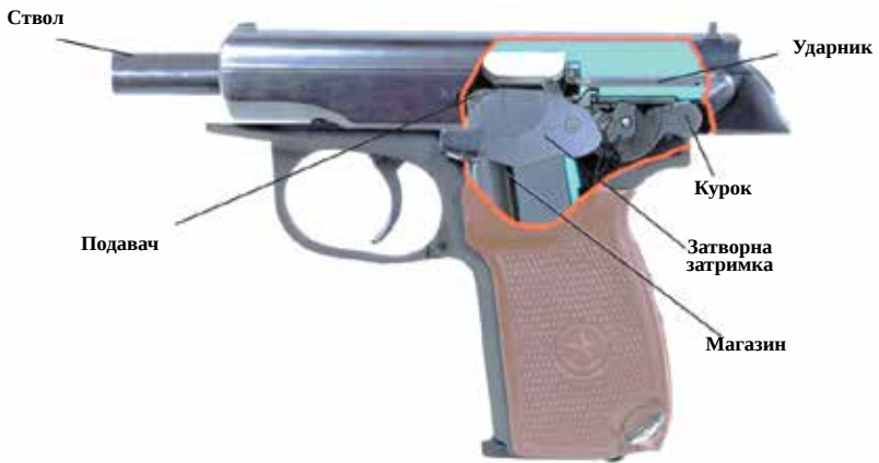
Розташування частин і механізмів пістолета Макарова
