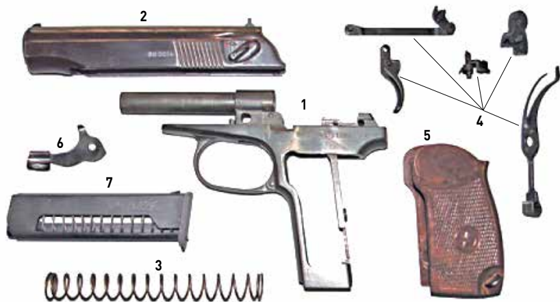
1 — рамка зі стволом та спусковою скобою; 2 — затвор; 3 — повертаюча пружина; 4 — ударно-спусковий механізм; 5 — рукоятка з гвинтом; 6 — затворна затримка; 7 — магазин
